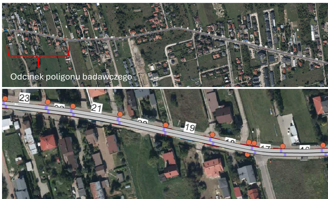
Rys. 5. Widok odtworzonego poligonu w programie AIMSUN (numer – nr pola, kolor fioletowy – detektor, kolor pomarańczowy – oprawa oświetlenia)
